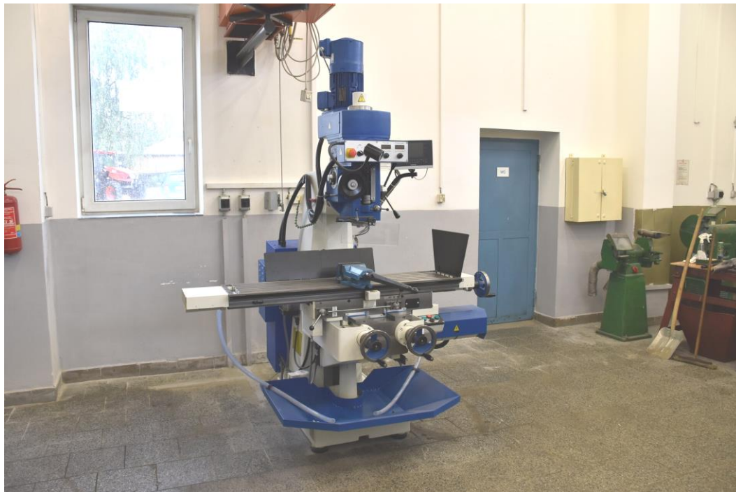
Obrázek č. 25: Moderní pomůcky zakoupené z dotace MZe 129 710 „Centra odborné přípravy“ – konzolová frézka vertikální FNT 50
