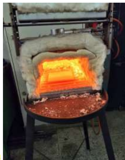
Ohřev ocelového podstavce v kovářské peci
